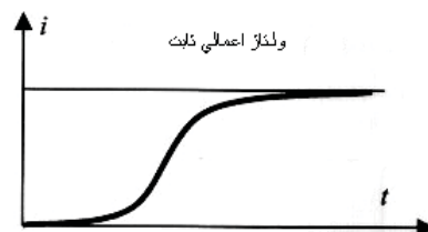
شکل ۳-۱: منحنی جریان-زمان یا اعمال ولتاژ DC برای سیم پیچ ترانسفورماتور
