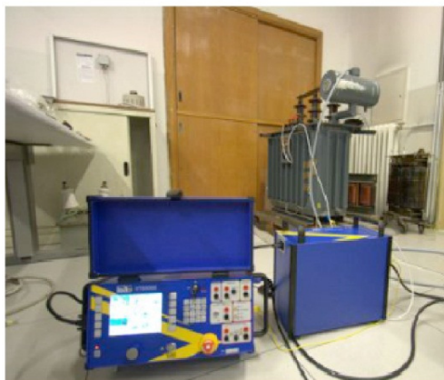
شکل (۴): تصاویری از نمای واقعی اتصالات و تجهیزات تست ضریب تلفات عایقی بوسیله پل شرینگ
