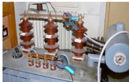
شکل (۴): تصاویری از نمای واقعی اتصالات و تجهیزات تست ضریب تلفات عایقی بوسیله پل شرینگ
