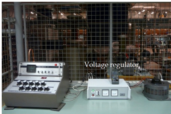
شکل (۳): چیدمان کلی پل شرینگ و حفاظت‌های مربوطه
