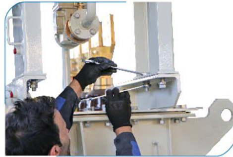
شکل ۳-۱۲ نحوه آچارکشی شیر نمونه گیری و منبع انبساط
