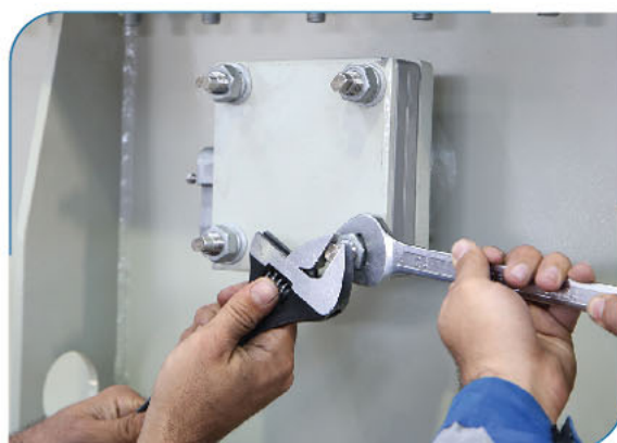
شکل ۳-۱۰ نحوه باز کردن پیچ دو سر رزوه
