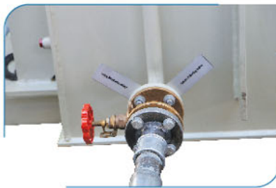
شکل ۳-۱۵ نحوه تزریق روغن
