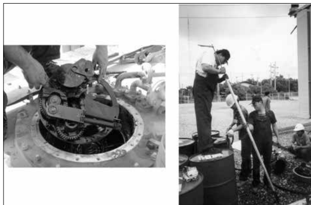
شکل نه: شستشوی مجموعه‌ی جعبه‌دنده
