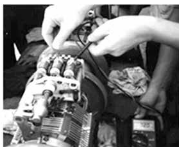
شکل پانزده: اندازه‌گیری مقاومت‌های تپ‌چنجر
