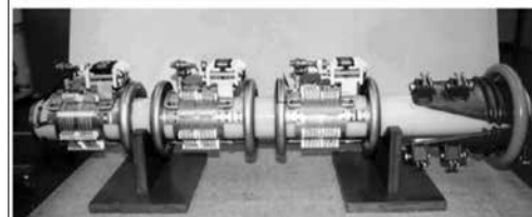
شکل چهارده: نصب صفحه‌های فلزی به عنوان نگهدارنده در زیر جرقه‌گیرهای بین فازها در تپ‌چنجرهای مدل V با اتصال دلتا
