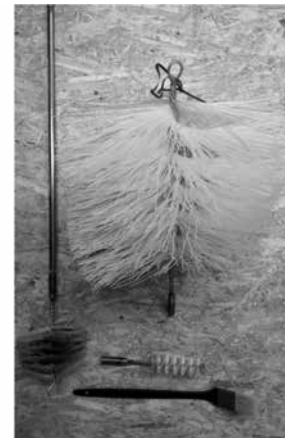
شکل هشت: ابزار شستشوی سلکتور سوئیچ و محافظی روغن تیپ‌چنجر
