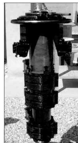
شکل دو: نمونه‌ای از تپ‌چنجر تحت بار که نیاز به سرویس دارد
