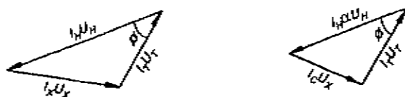
شکل ۷۸- نمودارهای فازی برای توان در ترمینالهای مربوطه و در سیم پیچهای فیزیکی
